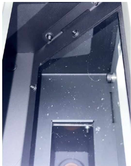
➤ Wie bei der Linse kann auch beim Spiegel eine Verschmutzung die Leistung des 3D-Druckers mindern.
