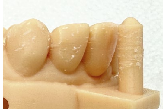
➤ Durch Streulicht entstandene raue und ungenaue Oberfläche des Modells
